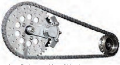
Sumber: Dokumen Kemdikbud Gambar 2.21 Gear sepeda adalah contoh roda berporos
