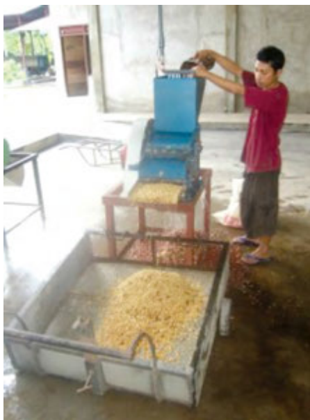
Gambar 1 Alat Pengupas Kulit Buah Kopi
