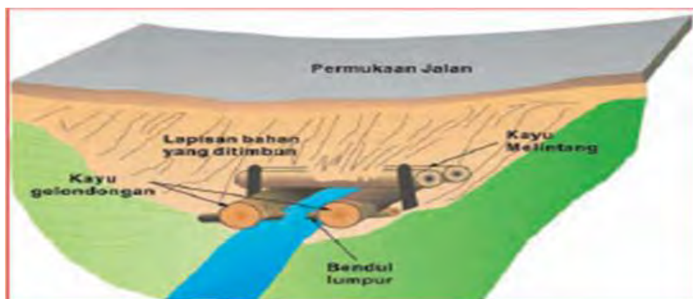
Gambar 39. Sketsa gorong-gorong terbuat dari kayu log.
