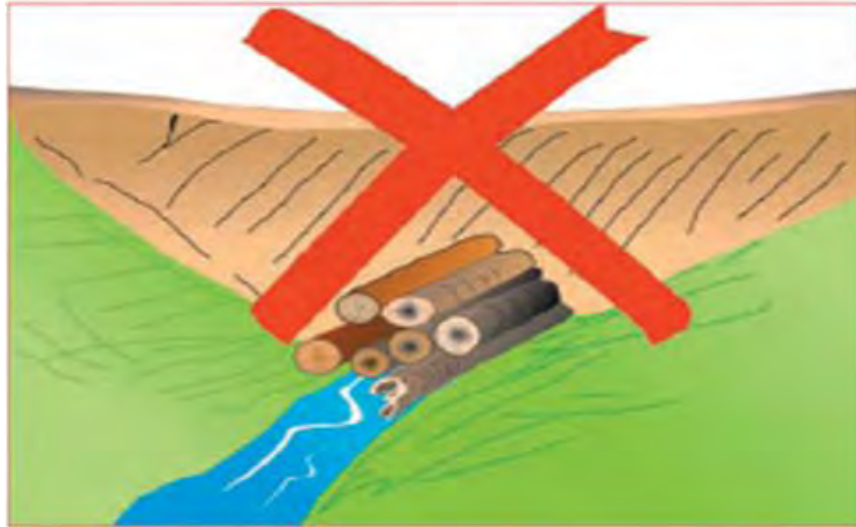
Gambar 38. Pembuatan Goronggorong Yang Salah Maka Perlu Dihindari Menggunakan Tumpukan Kayu Gelondongan Atau Puing Kayu Untuk Membuat Gorong-Gorong.
