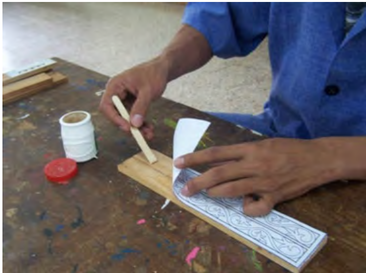
Gambar 1.59. Menempel gambar kerja
