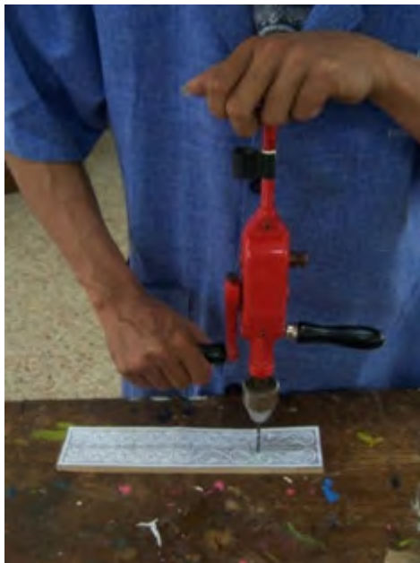
Gambar 1.61. Mengebor bagian yang akan disekrol
