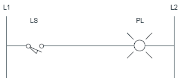
Gambar 2. 61 Sebuah rangkaian rele dengan saklar batas yang digunakan untuk mengendalikan lampu.
