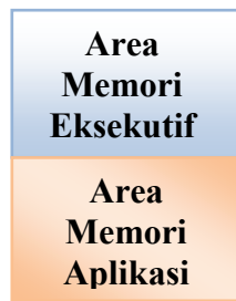
Gambar 2. 46 Diagram blok yang disederhanakan dari sistem memori PLC.
