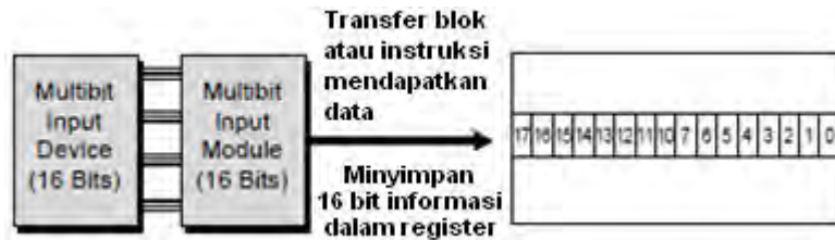
Gambar 2. 72 Transfer blok dan perolehan data input instruksi transfer multibit ke dalam table data.
