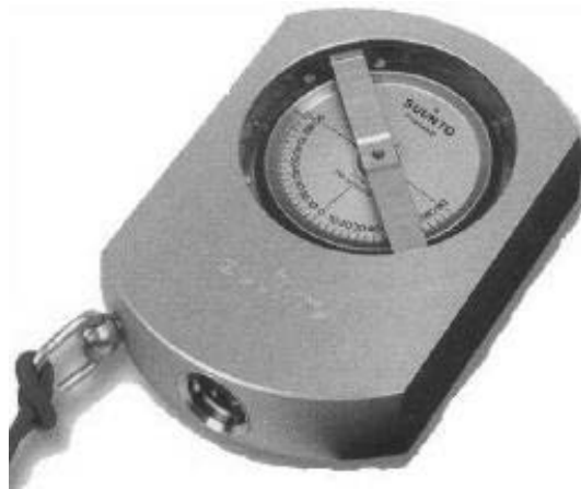
Gambar 31. Klinometer Merk Suunto
