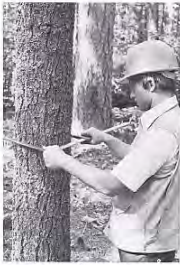
Gambar 35. Pengukuran diameter pohon menggunakan kaliper Sumber : Lorimer (1982)
