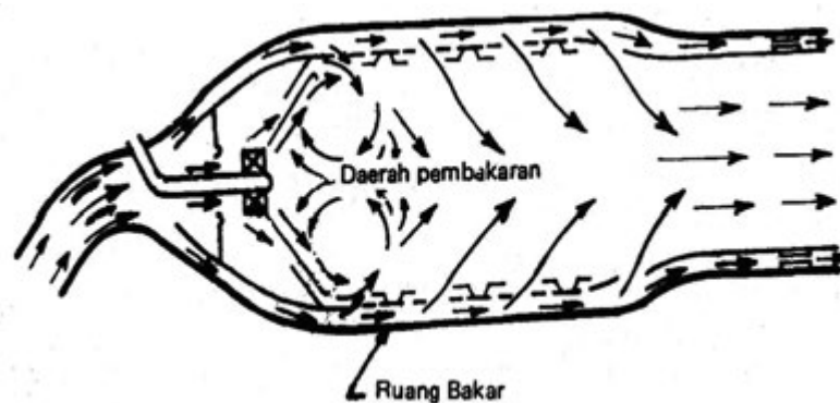
Gambar -6 Proses pembakaran dalam ruang bakar
