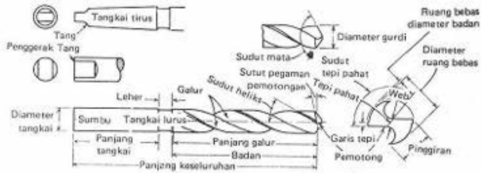
Gambar 1.32 Bagian-bagian mata bor
