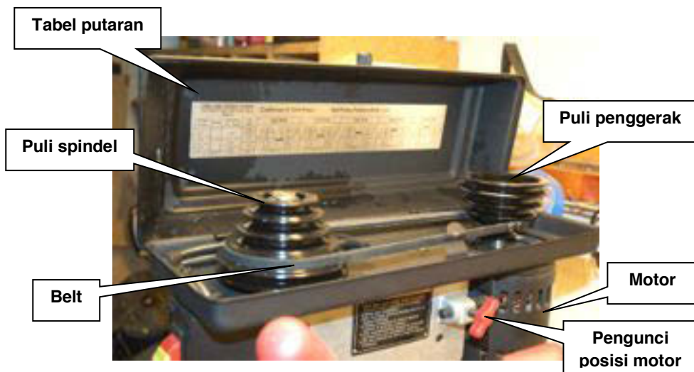
Gambar 6.5 Transmisi bor lima tingkat
