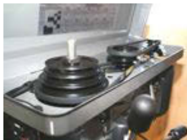
Gambar 6.6 Transmisi bor 12 tingkat kecepatan
