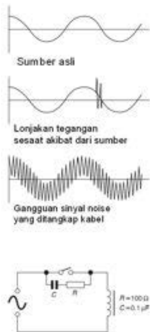
Gambar 4.5.: Distorsi pada kabel dan peredaman
