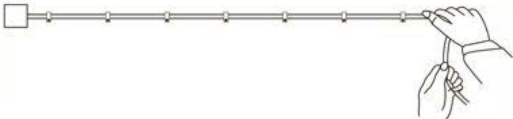
Gambar 3.1.: Pemasangan kabel lurus horisontal
