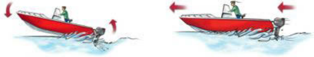
Gambar 12.1.: (a) Tanpa trims tab dan (b) dengan trims tab
