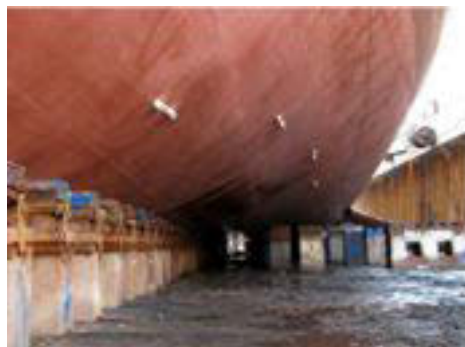
Gambar 8.20:: Pengorbanan anoda pada lambung kapal
