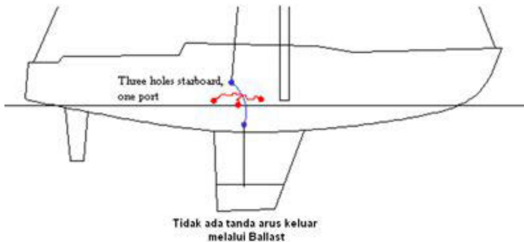
Gambar 11.14.: Petir merusak landasan perahu pada air tawar
