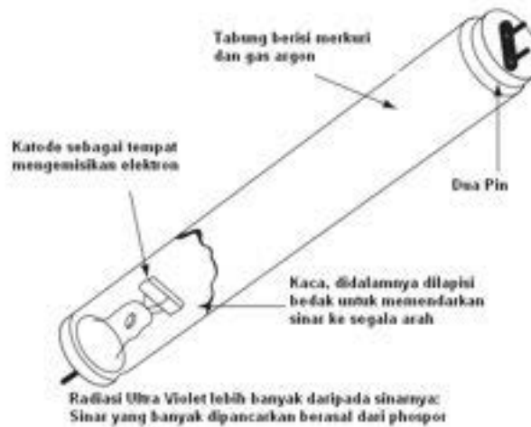
Gambar 10.24.: Konstruksi lampu fluorensen
