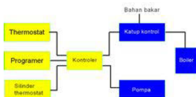
Gambar 3.4.: Skema blok diagram rangkaian kontrol pemanas ruang
