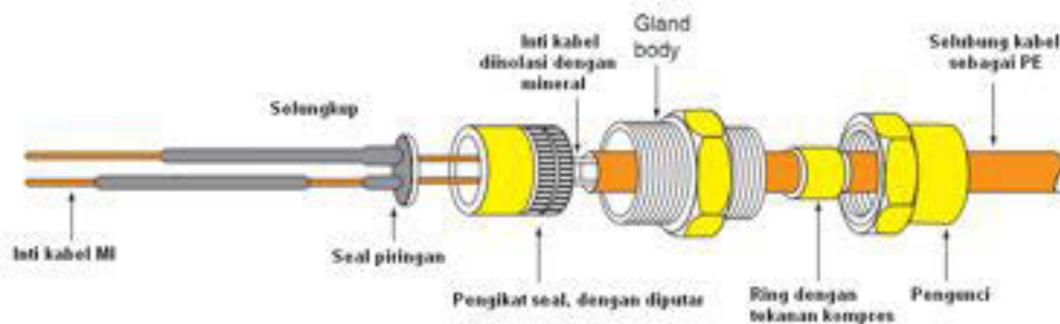
Gambar 6.4.: Sambungan MICC dengan kabel glands
