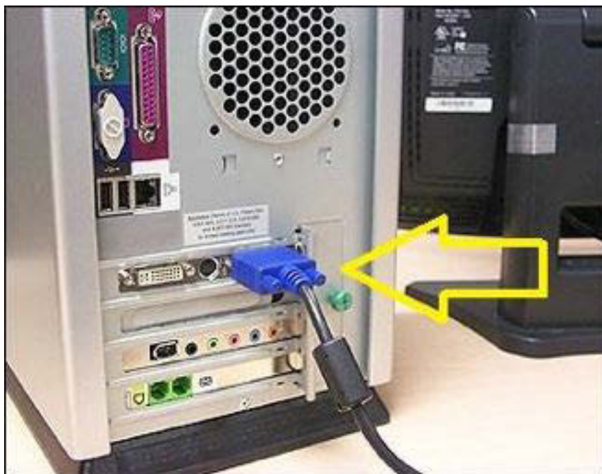
Gambar contoh pemasangan kabel vga ke cpu.
