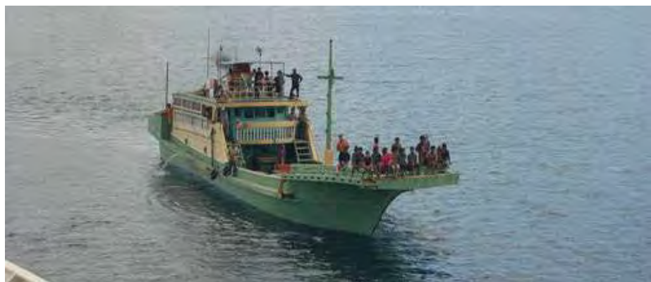
Gambar 168. Konstruksi kapal pole and line kayu, panjang 17 m lebar 4 m
