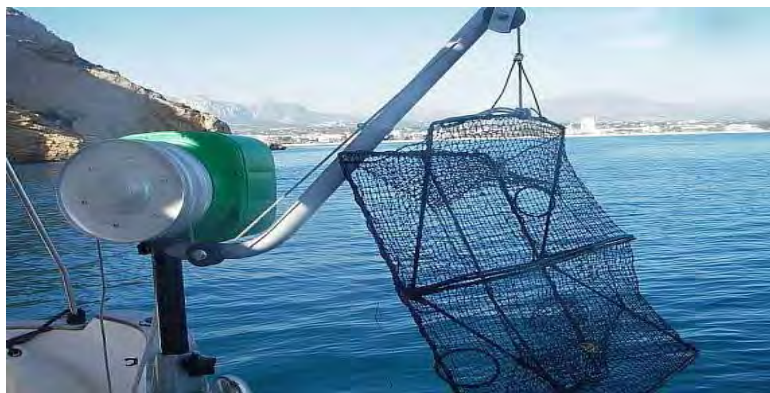
Gambar 120. Line hauler kecil untuk menarik tali perangkap. Mampu menarik tali 15 m/detik
