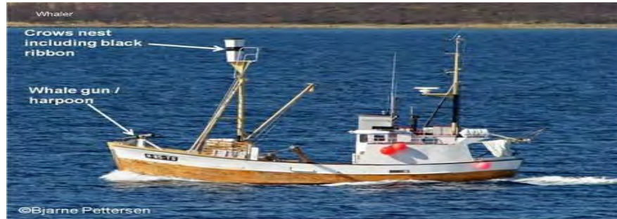
Gambar 187. Kapal paus dengan harpun dan pos pengamat di haluan
