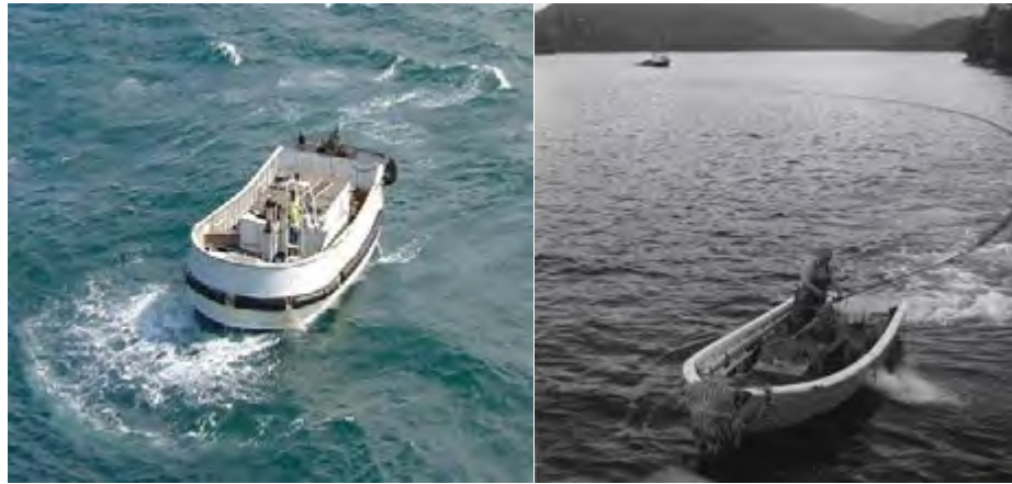
Gambar 134. Skiff boat pada kapal purse seine tuna membantu setting dan hauling
