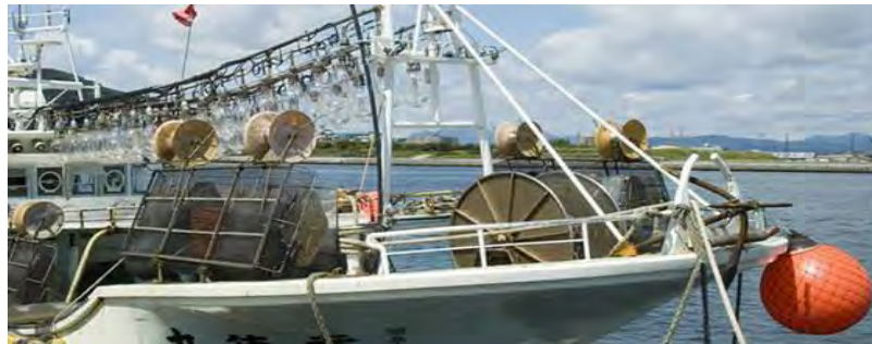
Gambar 165. Kapal pancing cumi dengan rak yang dilipat ketika tidak digunakan
