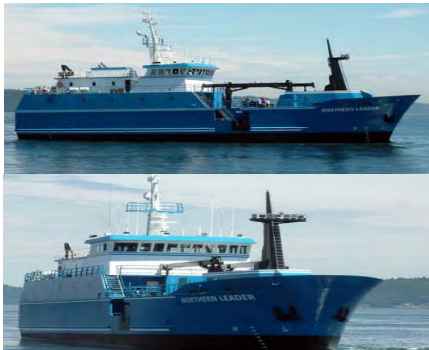
Gambar 175. Kapal longline tuna, 1.600 GT. Panjang 56 m
