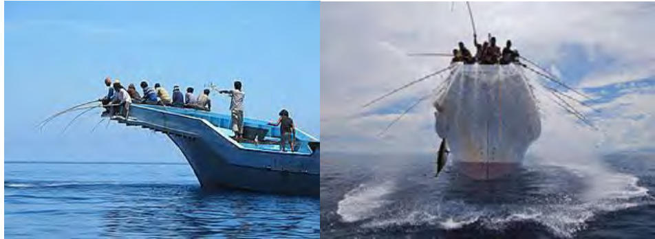
Gambar 169. Kapal pole and line dengan flying deck tempa pemancing di haluan kapal
