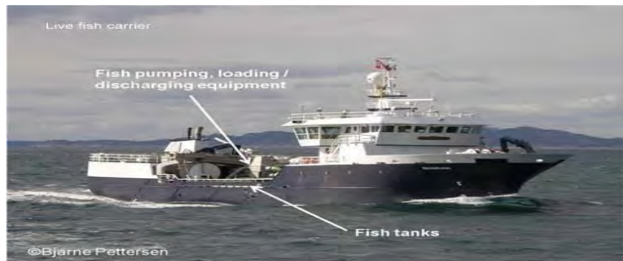
Gambar 194. Kapal pengangkut ikan hidup dengan tangki ikan
