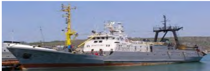
Gambar 202. Kapal riset klas Vasily Yakovenko untuk penelitian daerah penangkapan trawl dan purse seine
