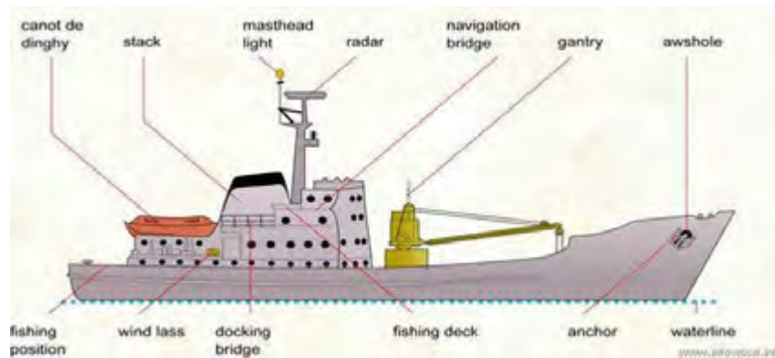
Gambar 138. Bagian-bagian kapal trawl
