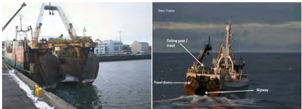
Gambar 150. Ciri khas kapal stern trawl terdapat slipway pada bagian buritan
