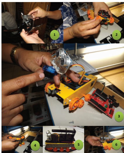
Gambar 6.13 Rangkaian elektronika kendali otomatis pada robot
