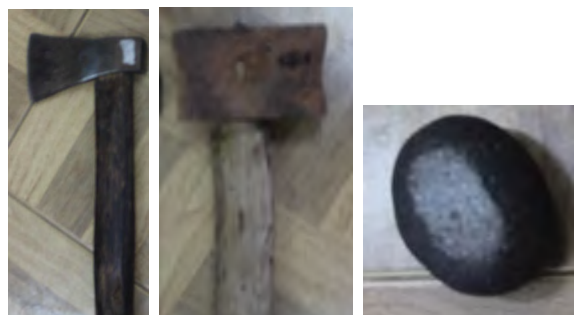
(Sumber: Dok. Kemdikbud) Gambar 4.13 Jenis palu: a) palu besi; b) palu kayu; c) batu
