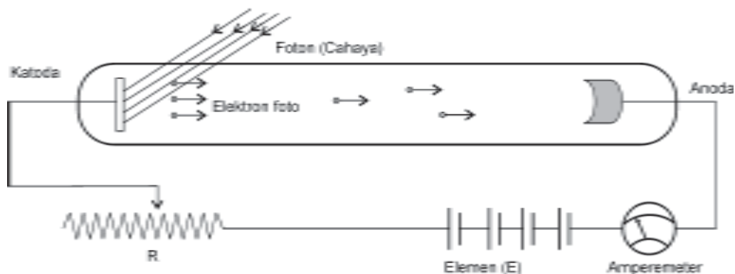
Gambar 7.4 Skema alat untuk menyelidiki efek fotolistrik
