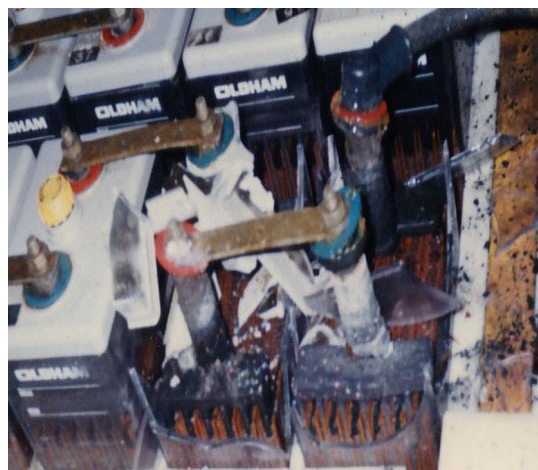
Gambar 1.64. Beberapa Contoh Temuan pada Sel Baterai yang Abnormal Kontainer Sel Baterai Pecah
