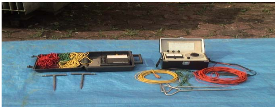
Gambar.2.35 Meter Tahanan Pentanahan
