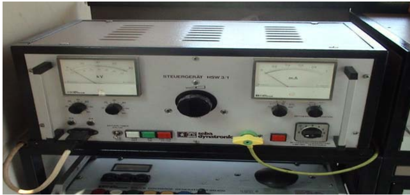
Gambar 2. 37 Tester Tegangan Tinggi Arus Searah Tester 20 kV Untuk memeriksa adanya tegangan pada kabel masuk / keluar kubikel
