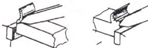
Gambar 109. Posisi pahat pada saat akhir pemahatan
