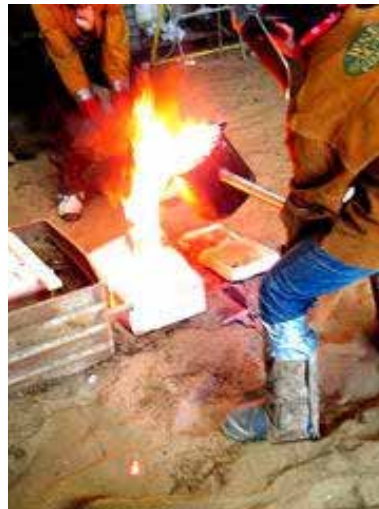
Gambar 1. Logam cair sedang dituangkan ke dalam cetakan
