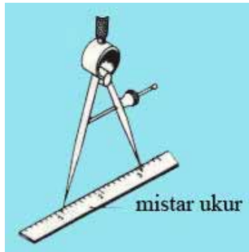
Gambar 41. Pengukuran dengan jangka tusuk
