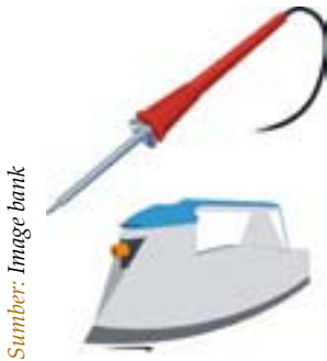
Gambar 9.2 Peralatan yang mengubah energi listrik menjadi energi panas
