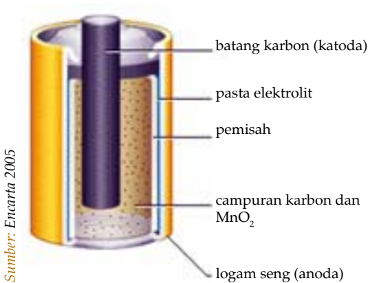
Gambar 8.6 Elemen kering (baterai)
