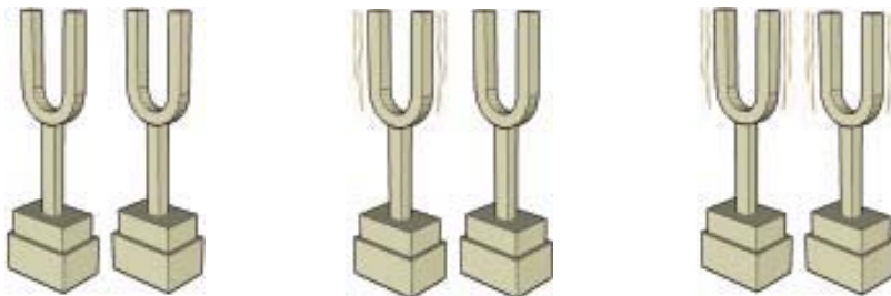
Gambar 7.10 Resonansi pada garputala dengan frekuensi sama.
