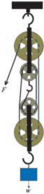
Gambar 6.13 Sistem katrol Sumber : Dokumentasi penulis
