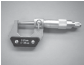
Mikrometer sekrup, terdiri dari skala utama dan skala putar
