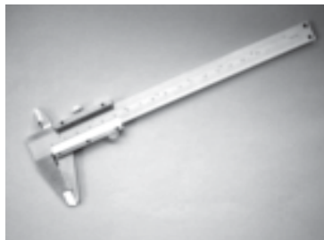
Jangka sorong terdiri dari skala utama tetap (fernier) dan skala geser (nonius)
