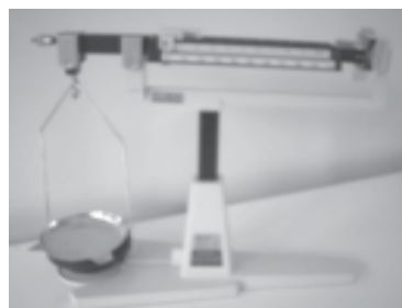
Neraca ohaus 311 gram, terdiri dari 4 lengan skala
