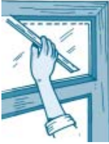
Gambar 5.5 Kaca dipasang agak longgar pada bingkainya
