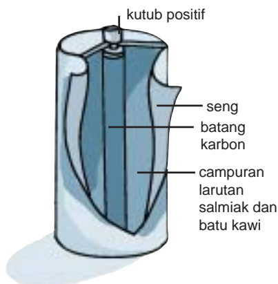
Gambar 9.1 Bagian-bagian baterai
